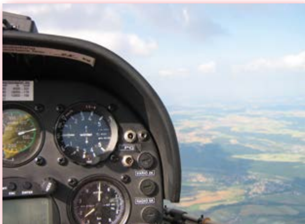
Alles im Blick! Das Amateurbrett eines Segelflugzeuges vom Typ LS8-18 mit dem Fahrtmesser (Sink- oder Steigflug) sowie dem Höhenmesser (unten rechts)
